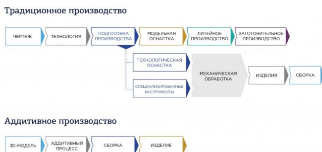
Рис. 1. Особенности производства в традиционных технологиях и аддитивных.
